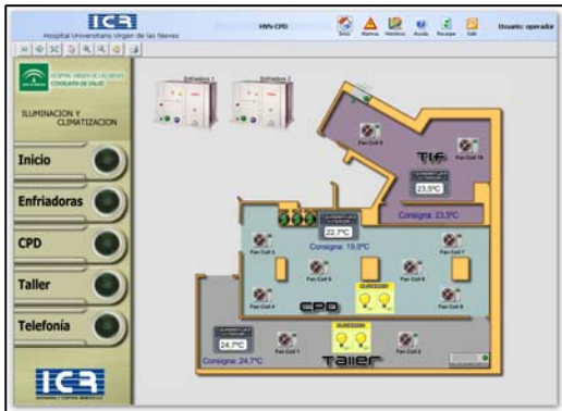
Gráfico 1. Primer sistema SCADA por medio de autómatas Xenta 511, Webservice.
